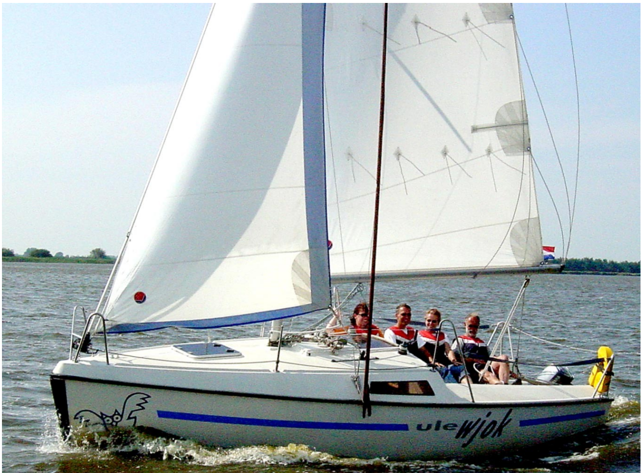
Afbeelding 11: Aan lijzijde beweegt de lucht sneller langs het zeil dan aan loef
