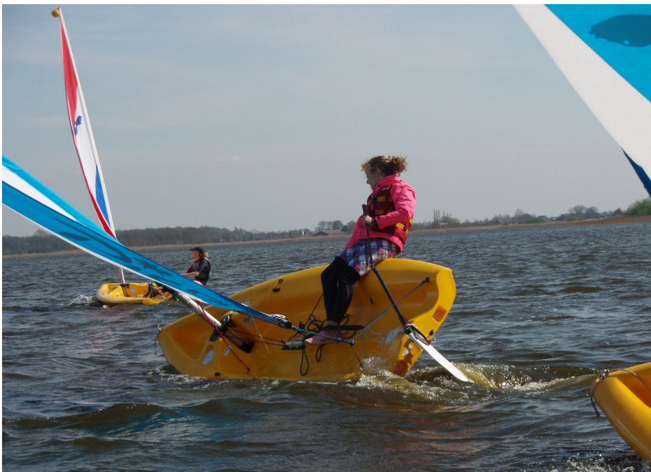
Afbeelding 17 Om nog rechtdoor te kunnen varen moet bij deze helling heel veel roer worden gegeven de kolk achter het roer is goed te zien. De anderen die veel minder helling hebben gaan veel sneller.
